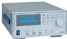
128kワードの内蔵メモリに格納された減衰量データを読み出すことによって、任意の減衰量パターンを発生。マイクロ波信号の振幅カーブを自由に作り出すことができます。読み出し速度は最高2μs/ワード、切り換え時のスパイクは発生しません。減衰量パターンは標準付属の「減衰量プログラム作成ソフトMAS800」を使い、PC上で作成して本器のメモリに転送。
